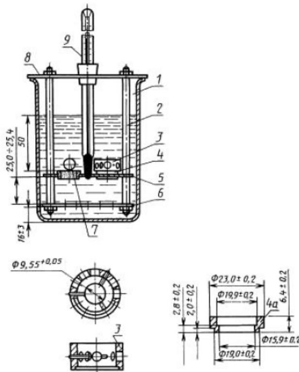
1 - стеклянный стакан; 2 - штатив; 3 - накладка; 4 - латунное ступенчатое кольцо; 5 - верхняя пластинка; 6 - нижняя пластинка; 7 - шарик; 8 - крышка; 9 - термометр
