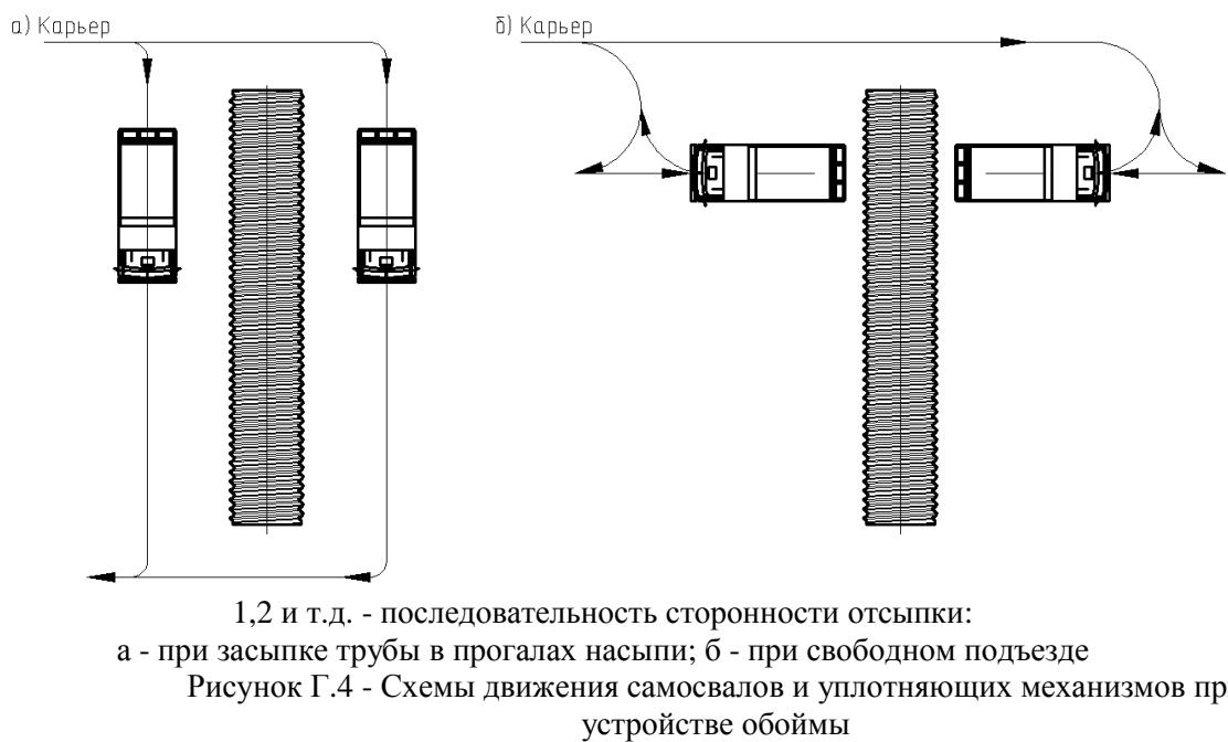
Рисунок Г.4 - Схемы движения самосвалов и уплотняющих механизмов при устройстве обоймы
