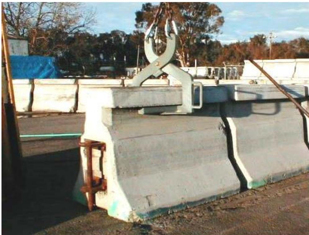
Рисунок 8 – Клещевое грузозахватное устройство для секций ограждения
