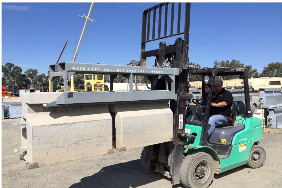
Рисунок 7 – Устройство для перемещения сдвоенных секций
