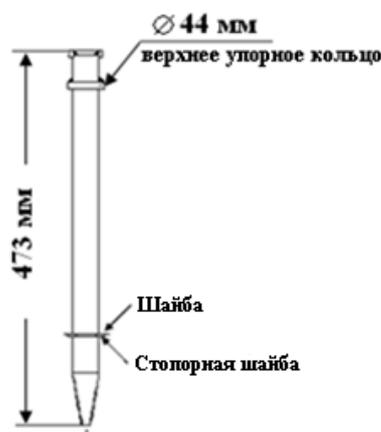
Рисунок 9 – Штырь с шайбой и стопорной шайбой для секции ограждения
