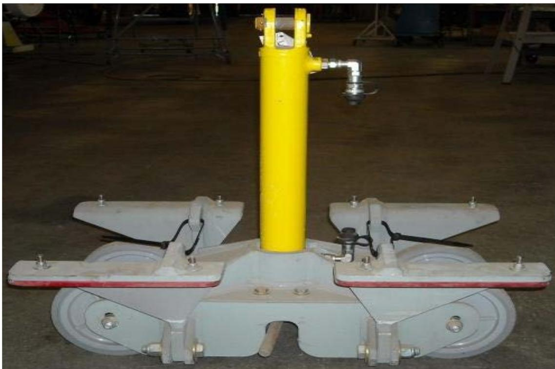
Рисунок 10 – Монтажный гидравлический инструмент для установки штырей
