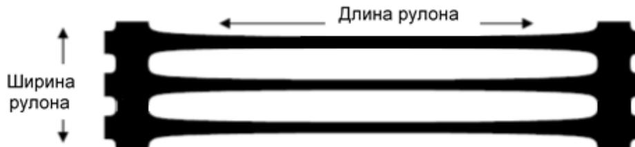
Рисунок 1 – Общая схема георешетки Tensar серии RE500
