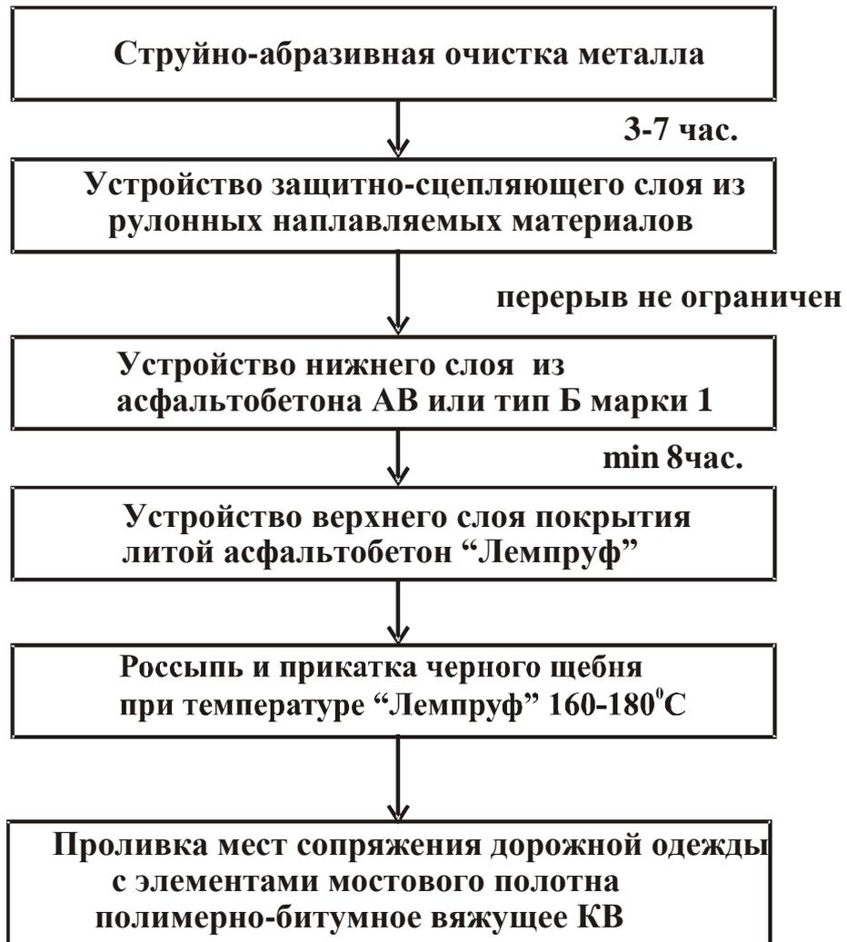
*Рисунок 11 - Схема технологического процесса устройства конструкции дорожной одежды на ортотропной плите проезжей части при устройстве защитно-сцепляющего слоя из рулонного наплавляемого материала*
