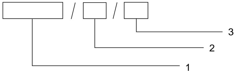
1 – наименование георешетки и ее номинальная разрывная нагрузка; 2 – размер ячейки в мм;
