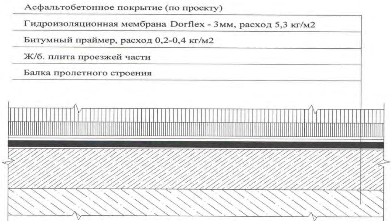
Рисунок 1 - Гидроизоляция железобетонной плиты мостового сооружения.
