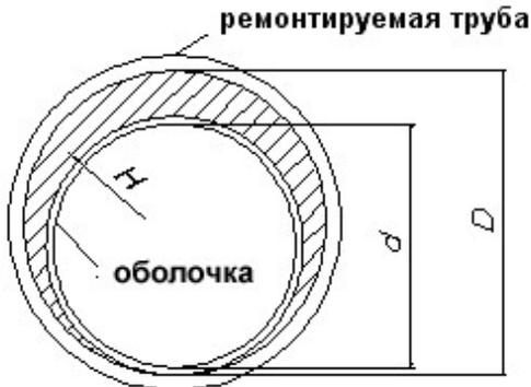
Рисунок 5 - обозначения, принятые в формуле (11)
