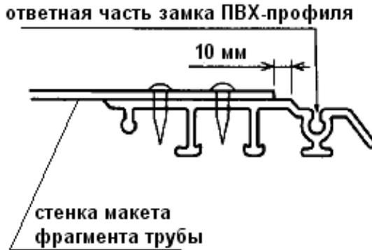
Рисунок Г.2 - Фиксация кольца из ПВХ-профиля в макете фрагмента трубы
