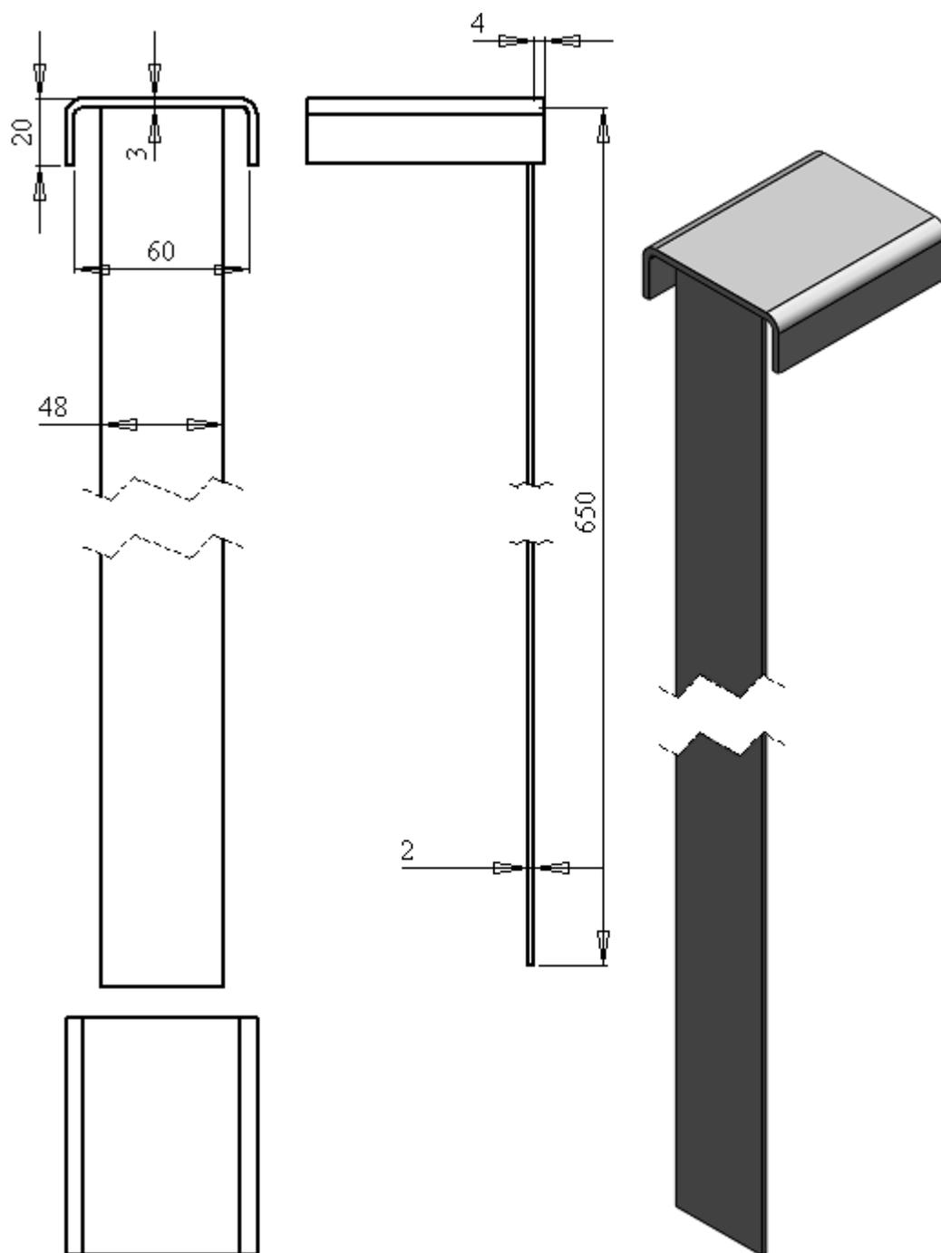
Рисунок А.6 – Крышка стойки с пластиной (вариант 1а, Табл.1 СТО)
