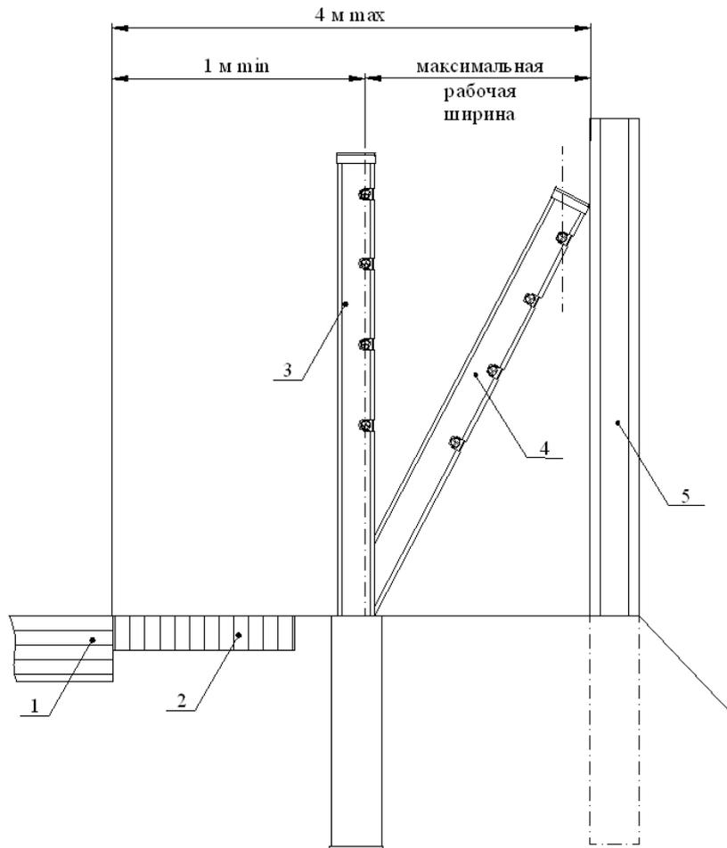
1 – проезжая часть; 2 – укрепленная полоса; 3 – недеформированное ограждение; 4 – деформированное ограждение; 5 – массивная опора
