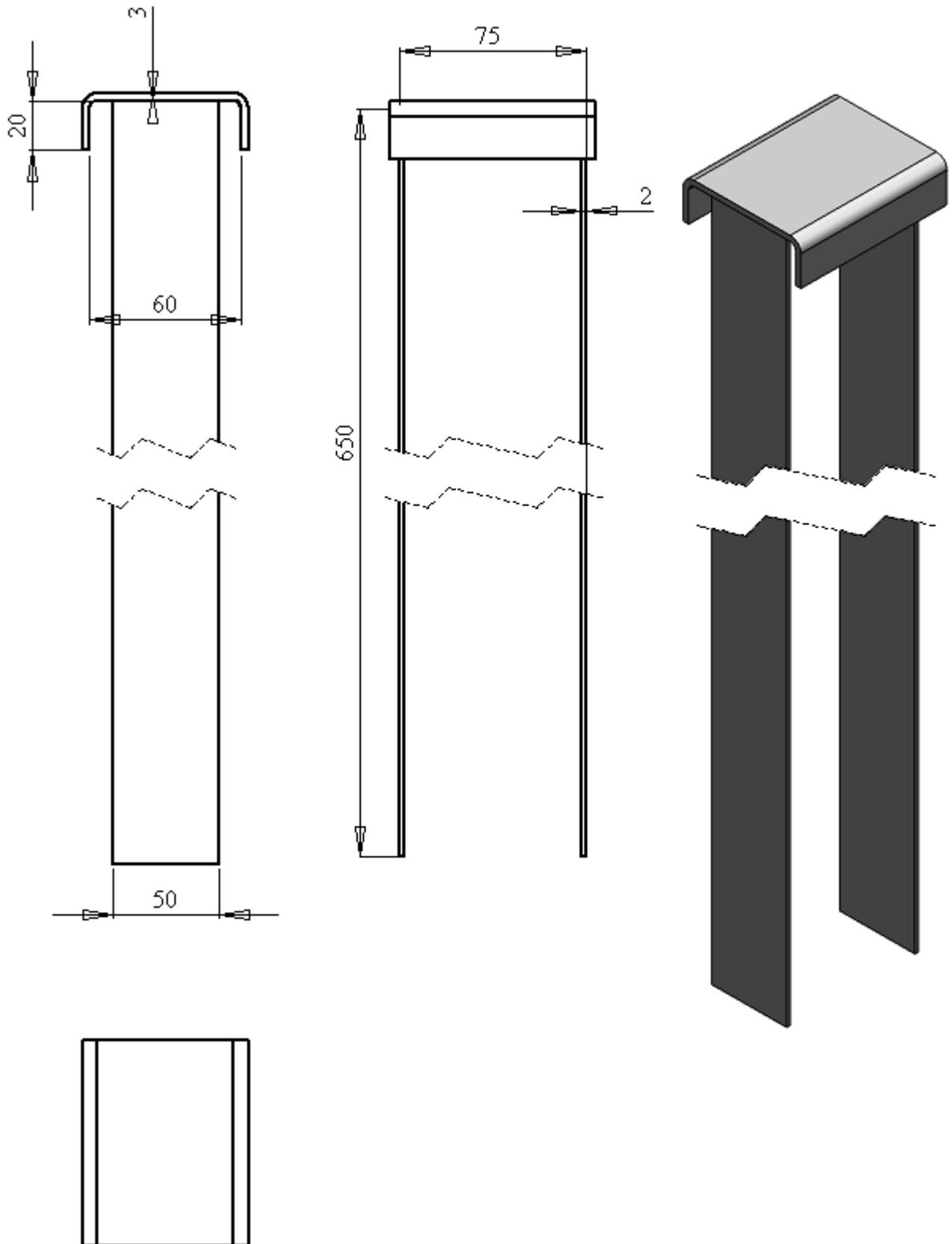
Рисунок А.7 – Крышка стойки с двумя пластиной (вариант 1б, Табл.1 СТО)
