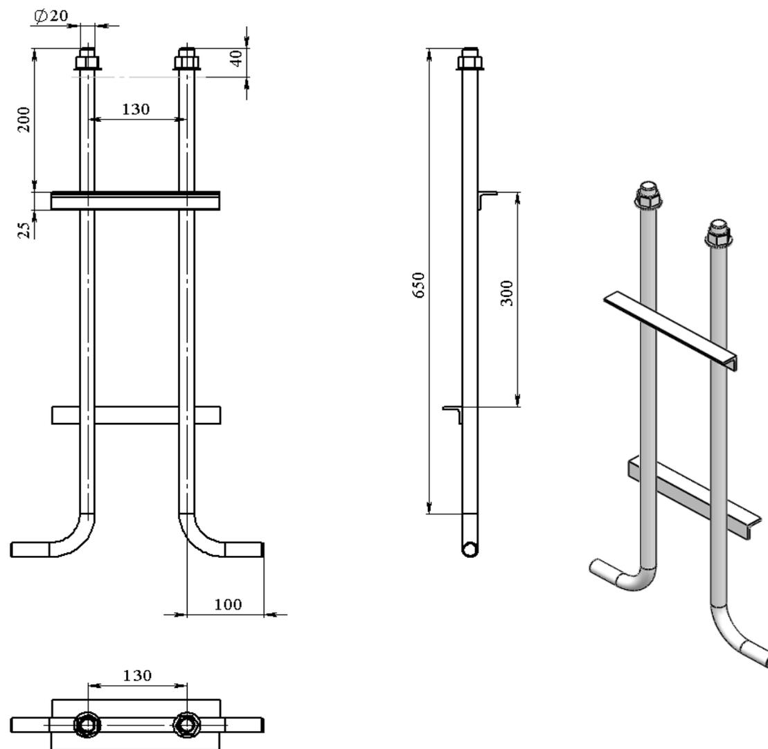
Рисунок А.13 - Устройство анкерное
