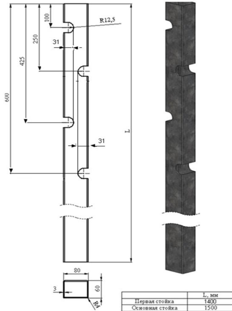
Рисунок А18 – Стойка (вариант 4 СТО, Таблица 1)
