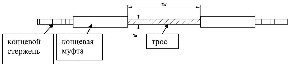
Рисунок 2 – Испытательный образец для испытаний троса на растяжение
