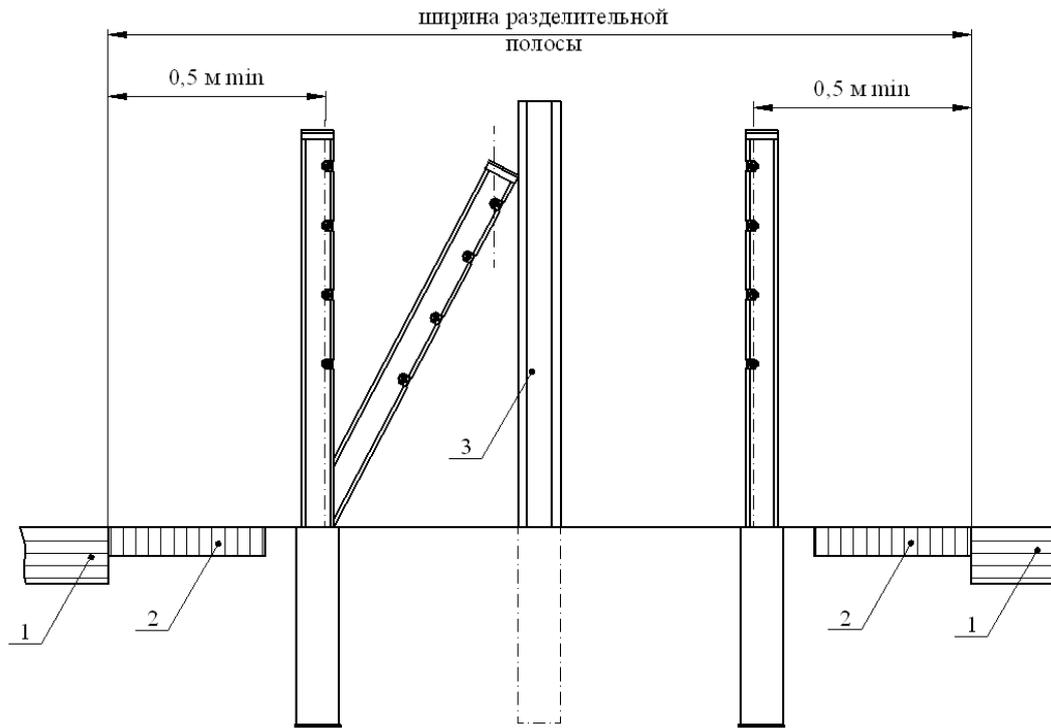
1 – проезжая часть; 2 – укрепленная полоса; 3 – массивная опора
