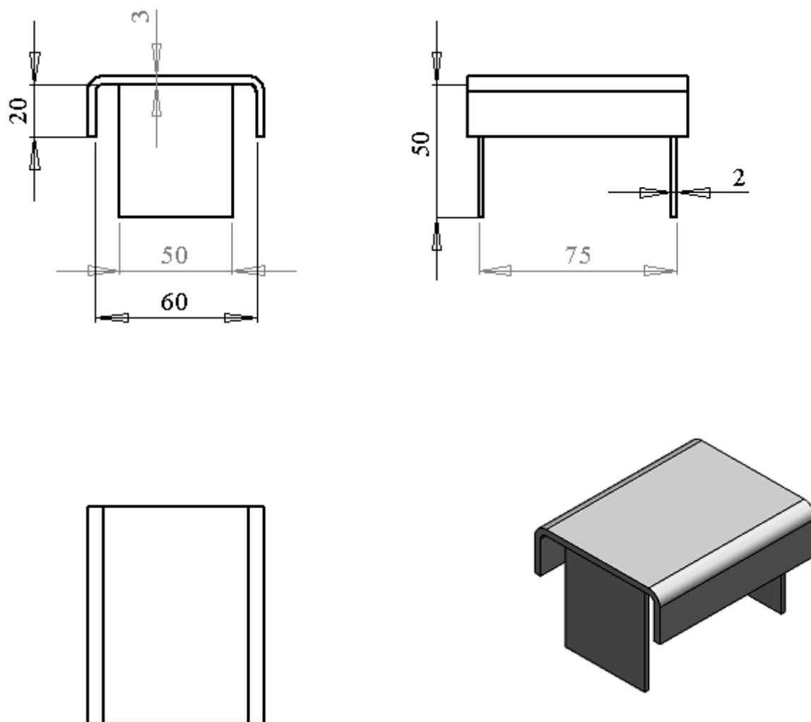
Рисунок А.8 – Крышка стойки (вариант 2, Табл.1 СТО)
