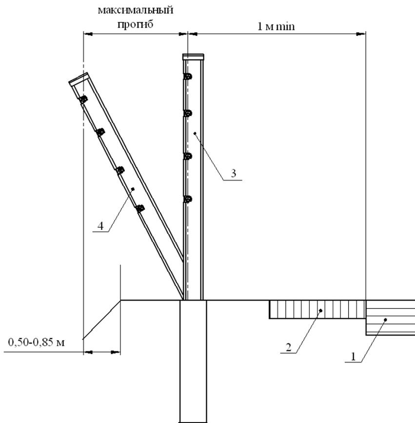
1 – проезжая часть; 2 – укрепленная полоса; 3 – недеформированное ограждение; 4 – деформированное ограждение
