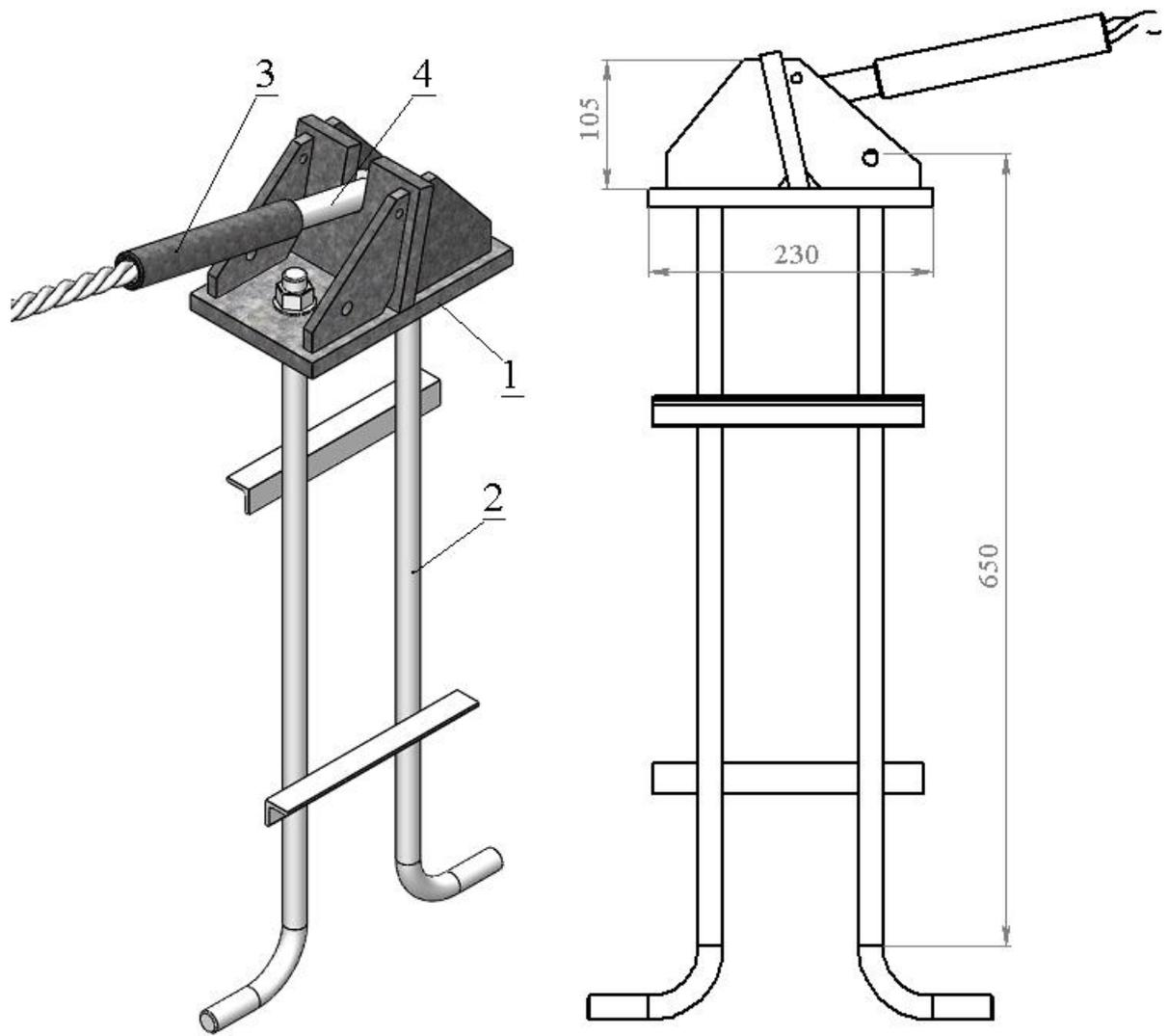
1 – анкерная плита, 2 – анкерное устройство, 3 – концевая муфта, 4 – концевой стержень
